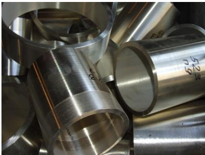
Рисунок 166. Втулки из сплава ЦАМ10-5
